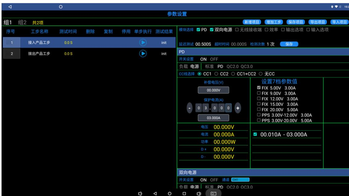
拨出产品工步：此工步不能删除，只做为判断是否拨出产品的功能，不作为测试参数工步。通道和参数设置要和接入测试工步的设置参数和通道一致。如下图：电流范围默认为0.000-0.010A，并勾选（注意，一定要勾选，电流范围一定小于实际测试值，才不会继续循环测试，延迟常规设1秒，不能设0），设置完后点击右上角的保存按钮 **保存**，如下图：
