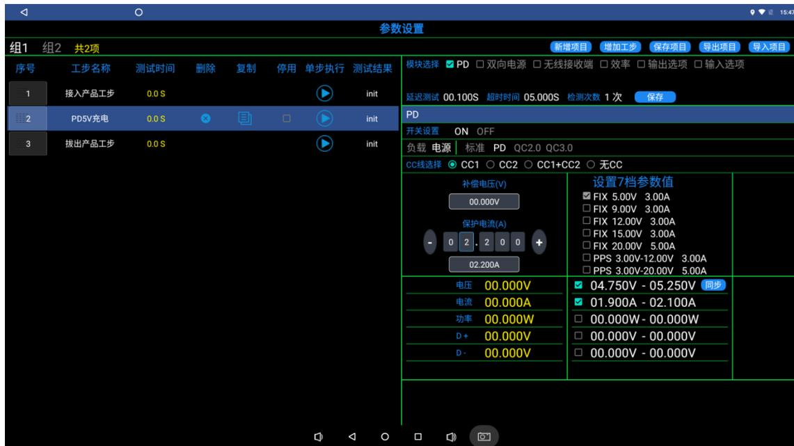
充电效率设置，以PD5V2A为例，勾选右上角的PD，效率，PD选择电源的PD协议，默认勾选FIX5V3A，点击下面的同步按钮 **同步**，效率勾选PD (D) - 双向电源 (T) 参数设置为80% - 90%，设置完后点击右上角的保存按钮 **保存**，如下图：
