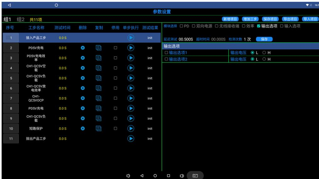
输入选项设置：输入选项主要作是自动化外部增量加信号触发启测试，此功能要编在接入产品工步上，只选输入选项，不能勾选其他模块。如下图：
