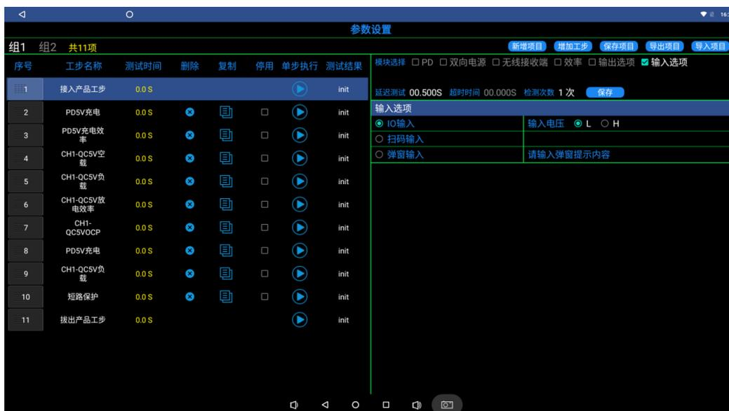
混合自动模式主界面如下图所示。类似于标准自动，可在参数设置界面增加测试工序，设定判定范围后一键执行测试。混合自动模式一二通道混合使用，一次只能测试一个产品，但是
