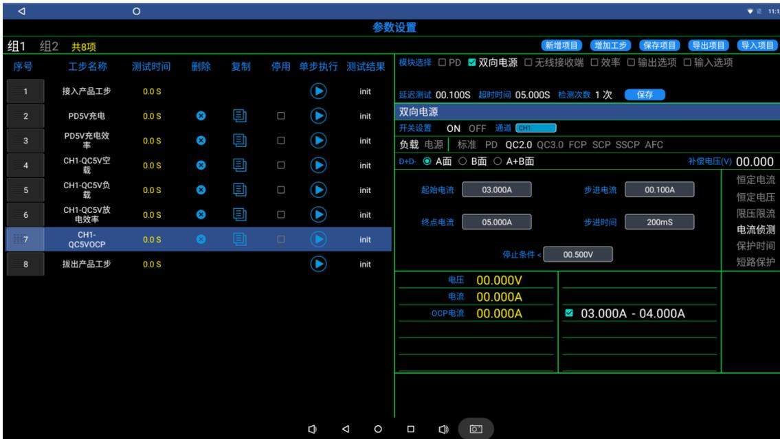
短路保护设置，勾选右上角的双向电源，打开开关通道选择CH-1，然后选择负载的QC协议，点击短路保护，电压设置0.000V-0.500V，电流设置0.000A-0.500A，并勾选，（常规短路时间设2S，延时设0.5S），设置完后点击右上角的保存按钮 **保存**，如下图：
