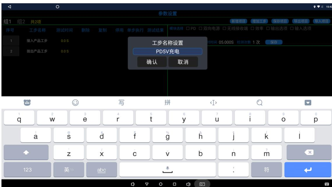
首先给移动电源设置PD5V2A充电，勾选右上角的PD，然后选择电源的PD协议，默认勾选FIX5V3A，点击下面的同步按钮 **同步**，电压设置自动按±5%计算上下限值，电流按实测设定范围，设置完后点击右上角的保存按钮 **保存**，如下图：
