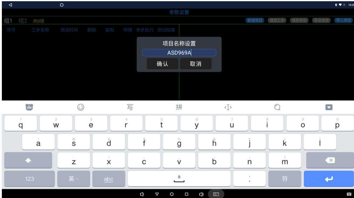
点击确认后，首先要设置好接入产品工步，此工步不能删除，只做为启动产品测试功能，不作为测试参数工步。通道和参数设置要和第1个测试工步的设置一致。如：打开电池和双向电源---选通道CH1---打开电源PD协议----默认勾选FIX5V3A，电流范围默认为0.010-3.000A，并勾选。设置完后点击右上角的保存按钮 **保存**，如下图：
