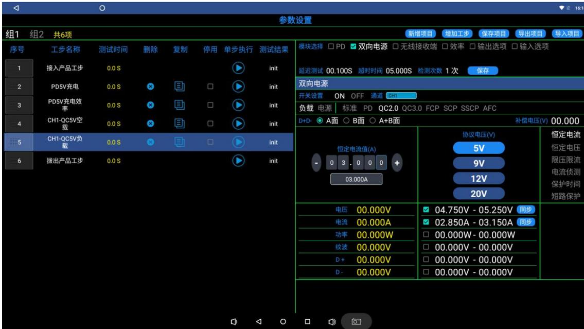
放电效率设置，以CH1-QC5V为例，勾选右上角的双向电源，效率；双向电源选择负载QC, 协议电压点击5V，恒定电流值设置为3A，点击同步按钮 **同步**，效率勾选PD (D) - 双向电源 (T) 参数设置为85% - 92%，设置完后点击右上角的保存按钮 **保存**，如下图：
