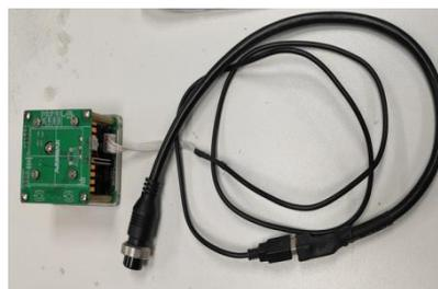
9158B 接收头编码器要拨码如下：5#代表组1的配套无线充接收地址。6#代表组2的配套无线充接收地址。
