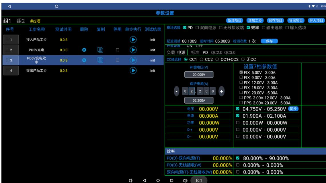
放电负载设置，点击双向电源，打开开关，通道选择CH-1，然后选择负载的QC协议，协议电压设置为5V，恒定电流值设置为3A，点击电压、电流的同步按钮 **同步**，电压、电流设置自动按±5%计算上下限值，设置完后点击右上角的保存按钮 **保存**，如下图：
