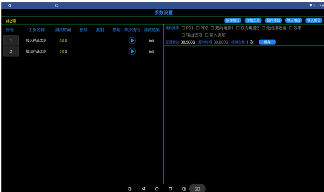
例如：一块移动电源，采用双向电源1的CH1通道作为PD5V电源输出，采用双向电源2的CH1通道作为QC负载受电。如此，第一组电源和第二组负载同时工作，便实现了边充边放功能。同理，可以设定工序为第一组和第二组均为负载，即实现双口同时带载功能。
